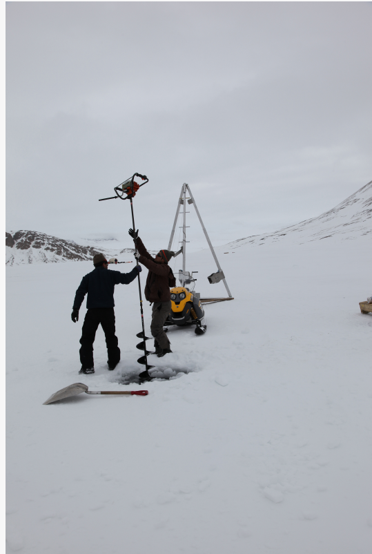
Nicholas Balascio et François Lapointe travaillant avec une tarière à glace pour forer dans la glace de 3,5 m d'épaisseur à South Sawtooth Lake, Canada. Crédit: Mark B Abbott.
