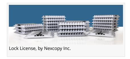
est par défaut un dispositif protégé en lecture seule ou en écriture. Le dispositif accepte un mot de passe de l'utilisateur pour déverrouiller le système par le biais du logiciel <u>Lock License de Nexcopy</u>. Cette nouvelle approche redonne le choix à l'utilisateur lorsqu'une clé USB est accessible en écriture.
