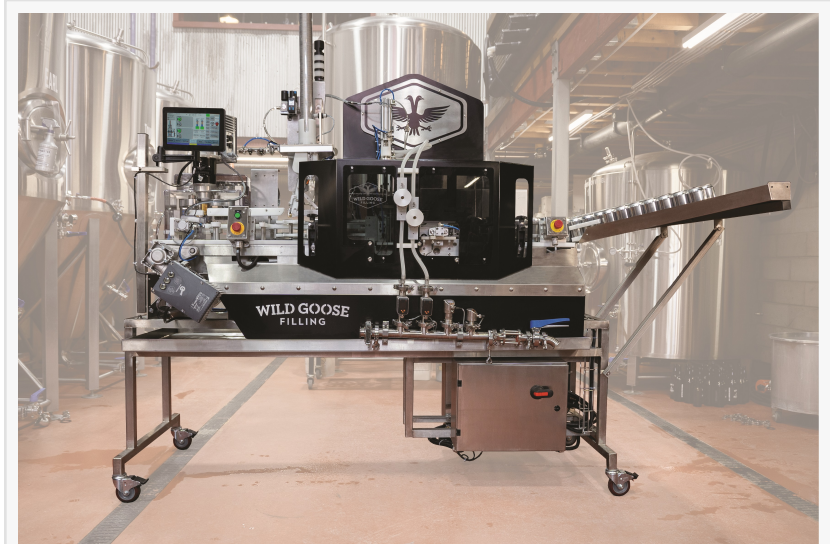
Le système d'encannage à contre-pression Wild Goose Fusion™ permet un encannage polyvalent et entièrement automatisé de boissons artisanales dans une large gamme de types de produits et de conditions.
