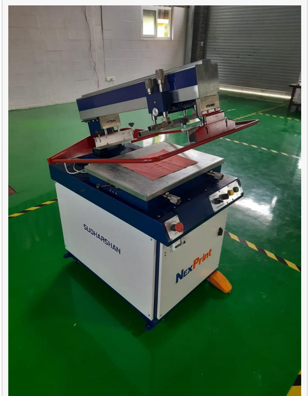
Nexprint, a mini screen printing machine
