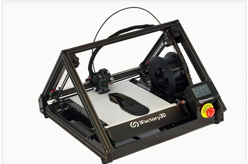
Der 3D-Fließbanddrucker von iFactory3D: Von deutschen Ingenieuren entwickelt, mit hochwertigen Komponenten fast ausschließlich aus Europa. Durch das Fließband können auf kleinstem Raum nahezu unendlich lange Objekt in additiver Serienfertigung realisiert werden.
