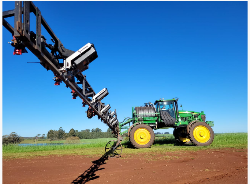
Sistema di irrorazione selettiva con l'utilizzo dell'intelligenza artificiale e telecamere
