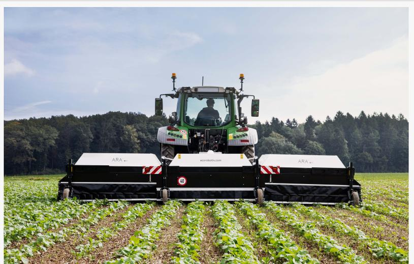
ARA - Pulverizador de Ultra-Alta Precisión de Ecorobotix
