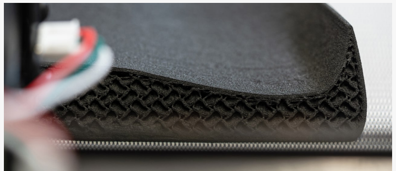
One Pro 3D-Banddrucker produziert orthopädische Einlegesohlen mit strukturierter Füllung für individuelle Dichte
