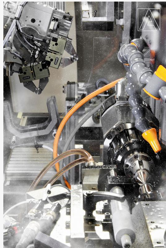
El cargador de piezas AF72 con su sistema de doble pinza para carga y descarga en paralelo y un brazo telescópico.
