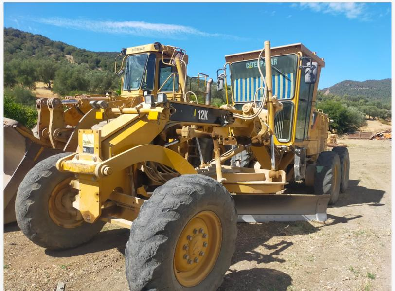
Une niveleuse 12k, engin de génie civil utilisé pour niveler les surfaces, prend une pause au parc. L'engin est impressionnant par sa taille et sa puissance, mais il est également surprenant de le voir dans un environnement aussi paisible.
