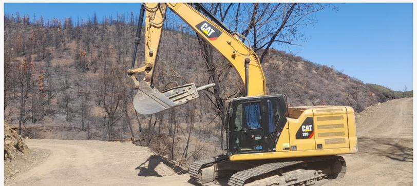
Pelle hydraulique Caterpillar 320 est à l'œuvre sur un chantier d'ouverture de piste. La pelle est équipée d'un marteau piqueur qui lui permettent de travailler dans des espaces restreints.
