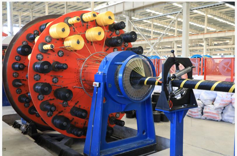
Fabricación de HVDC cables
