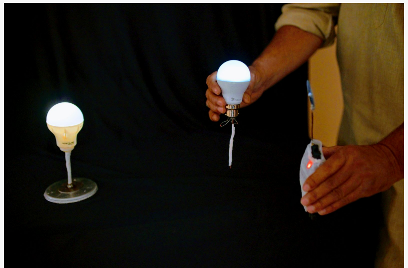
Das INFRGY-System zur Übertragung von Elektrizität über HF
