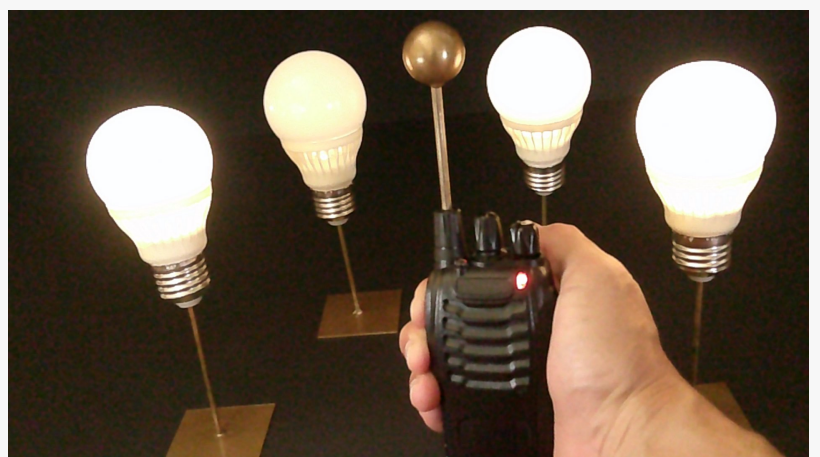
Demonstrasi Pemindahan Tenaga Tanpa Wayar menggunakan mentol lampu
