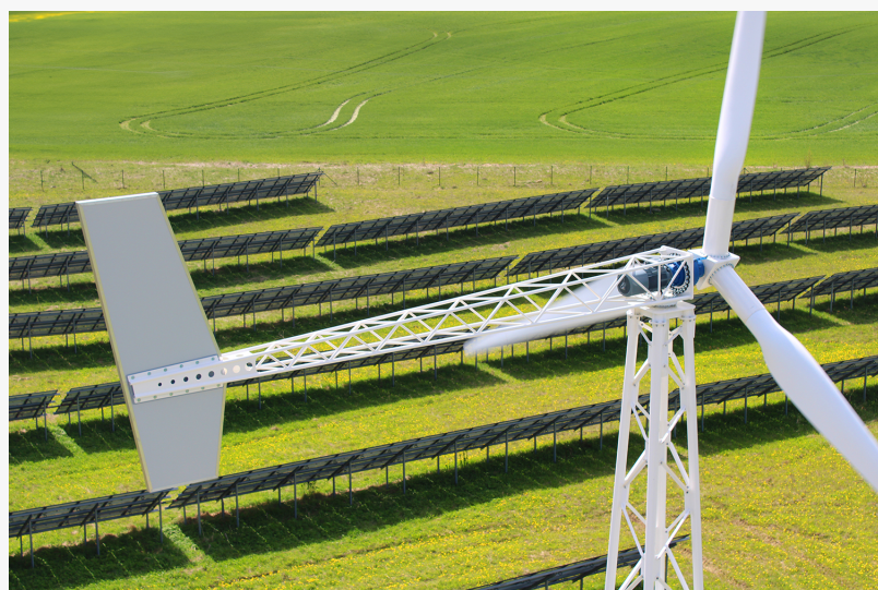
Turbina pozioma Freem-H20 20 kW firmy Freem w systemie hybrydowym
