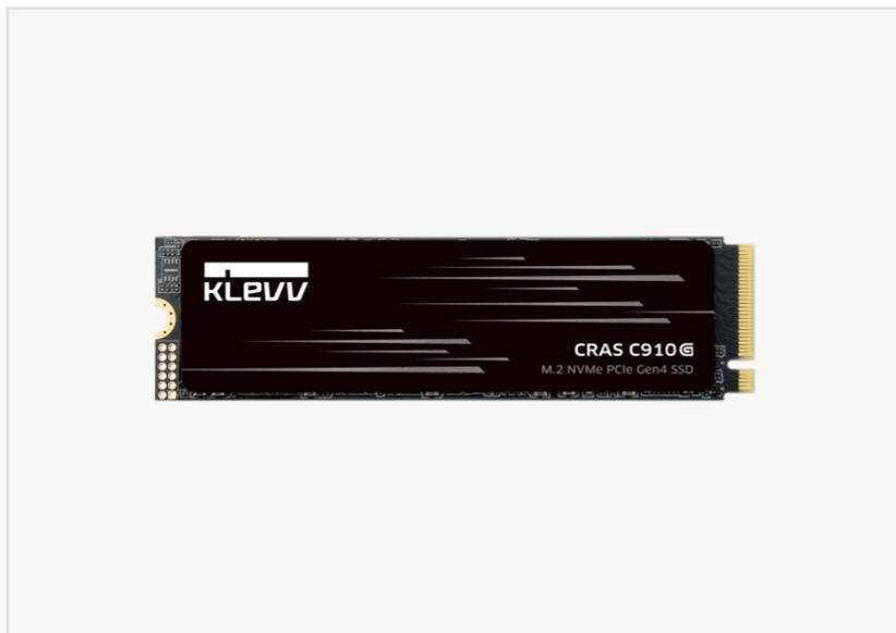
Dissipateur composite en graphène-cuivre ultra-mince pour un refroidissement avancé
