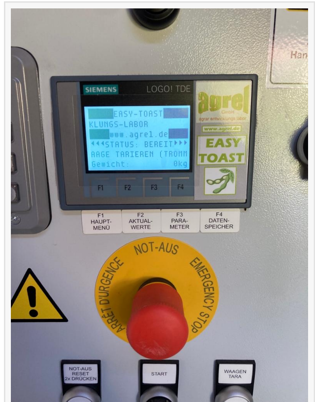
EASYTOAST Bedienpanel: Siemens-SPS, Kerntemperatur-Regelung und automatische Chargensteuerung
