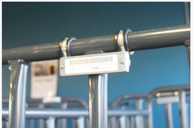
Xerafy Cargo OUT RFID Tags on Roll Cages
